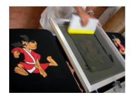
PASSO 07: Aplicamos a tinta Plastisol Gel Preto e depois a pré-cura com flash-sure.
