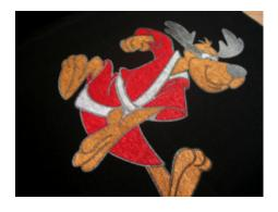
PASSO 06: Em seguida foi aplicada a tinta Plastisol Gel Vermelho Vivo seguida da pré-cura.
