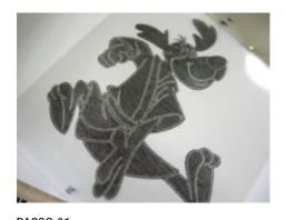
PASSO 01: O desenho é feito com o escaneamento de um bordado e um excelente software de separação de cores. Todas as matrizes usadas são de 43 fios/cm
