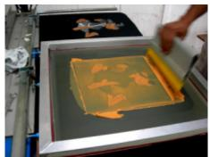
PASSO 05: Depois aplicamos a tinta Plastisol Gel Pele. Lembrar sempre de pré-curar depois de cada aplicação.
